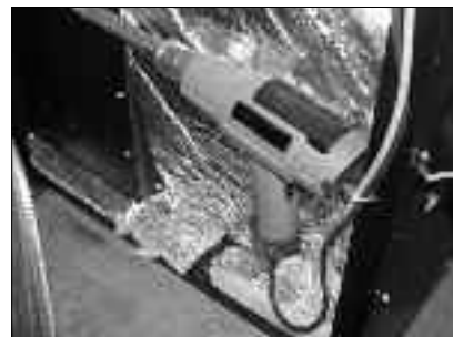
Bild D-14.2: Umleitblech herausnehmen
