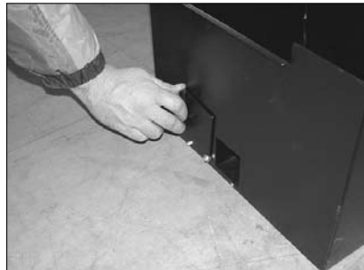
Bild C-9: Abdeckblech Aschebehälter öffnen
