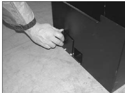
Bild C-7: Abdeckblech Aschebehälter schliessen
